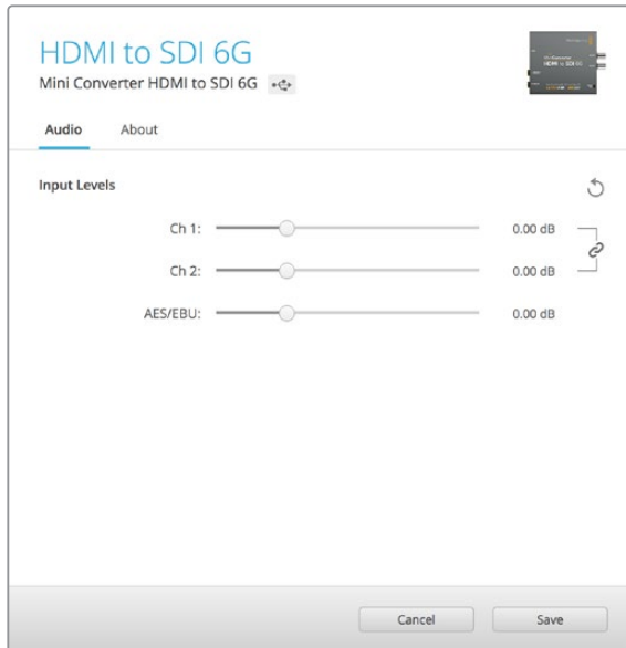
Converters Setupの「Audio」タブでオーディオレベルを調整します。
