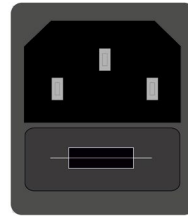
(REPLACE FUSE WITH SAME RATINGS) (REEMPLACER LE FUSIBLE AVEC LE MEME TYPE)
