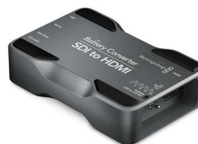
Perfetto per connettere le uscite SDI della telecamera ai monitor HDMI sul set, commuta automaticamente tra SD e HD e ospita un'uscita SDI di loop per connettere strumentazione aggiuntiva. Dispone di una batteria agli ioni di litio ricaricabile e di una caricatore per alimentazione esterna.
